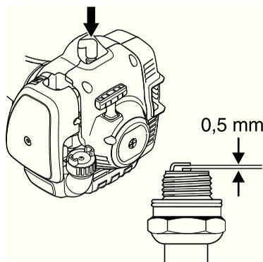
**ВНИМАНИЕ!** Всегда используйте только указанный тип свечи! Применение несоответствующей модели может привести к серьезным повреждениям поршня/цилиндра. Следите за тем, чтобы свеча была оснащена т.н. изоляцией радиопомех.
