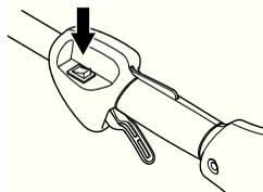
Запустите двигатель и проверьте, чтобы он остановился при переводе выключателя в положение стоп.
