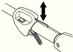
Проверьте, чтобы ручка газа и блокировочный рычаг перемещались свободно и чтобы возвратные пружины работали соответствующим образом.
