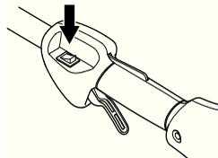
**ВНИМАНИЕ!** Контакт остановки автоматически возвращается в положение запуска. Во избежание непроизвольного запуска, колпачок зажигания следует всегда снимать со свечи зажигания при монтаже, проверке и/или обслуживании.
