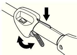
См. указания в разделе **Запуск**. Включите машину и полностью откройте дроссель. Отпустите рычаг дросселя и удостоверьтесь, что режущее оборудование останавливается и остается неподвижным. Если после постановки дросселя в положение холостого хода режущее оборудование продолжает вращаться, следует проверить регулировку холостого хода карбюратора. См. указания в разделе **Техническое обслуживание**.
