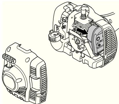
В странах с жарким и сухим климатом вероятность возникновения пожаров очевидна. Поэтому мы оборудуем некоторые глушители т.н. искроулавливающей сеткой. Проверьте, оборудован ли глушитель вашей машины такой сеткой.
