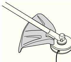
Проверьте, чтобы защита не была повреждена и чтобы на ней не было трещин. Замените защиту, если она была подвержена удару или если на ней есть трещины.
